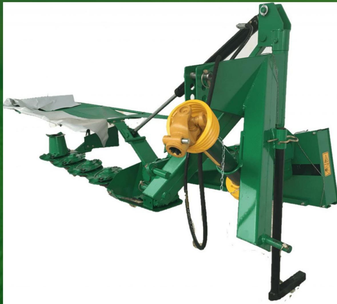
A Segadeira FL4/FL5 da AGROFORN de fabricação nacional, foi projetada para o corte de qualquer tipo de pastagens para a produção de feno e pre-secado. As segadeiras FL4/FL5 são de acoplamento rápido e simples em qualquer trator. A sua transmissão é feita por meio de cardan, podendo operar em aclives ou declives, realizando um corte perfeito, distribuindo de maneira uniforme e facilitando a sua secagem.
