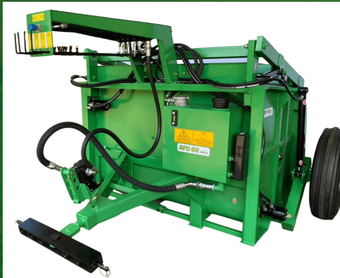
A Desensiladeira, mescladora e alimentadora AFD60/70/75 da AGROFORN, realiza as operações de desensilar, misturar e distribuir os materiais diretamente nos cochos.
