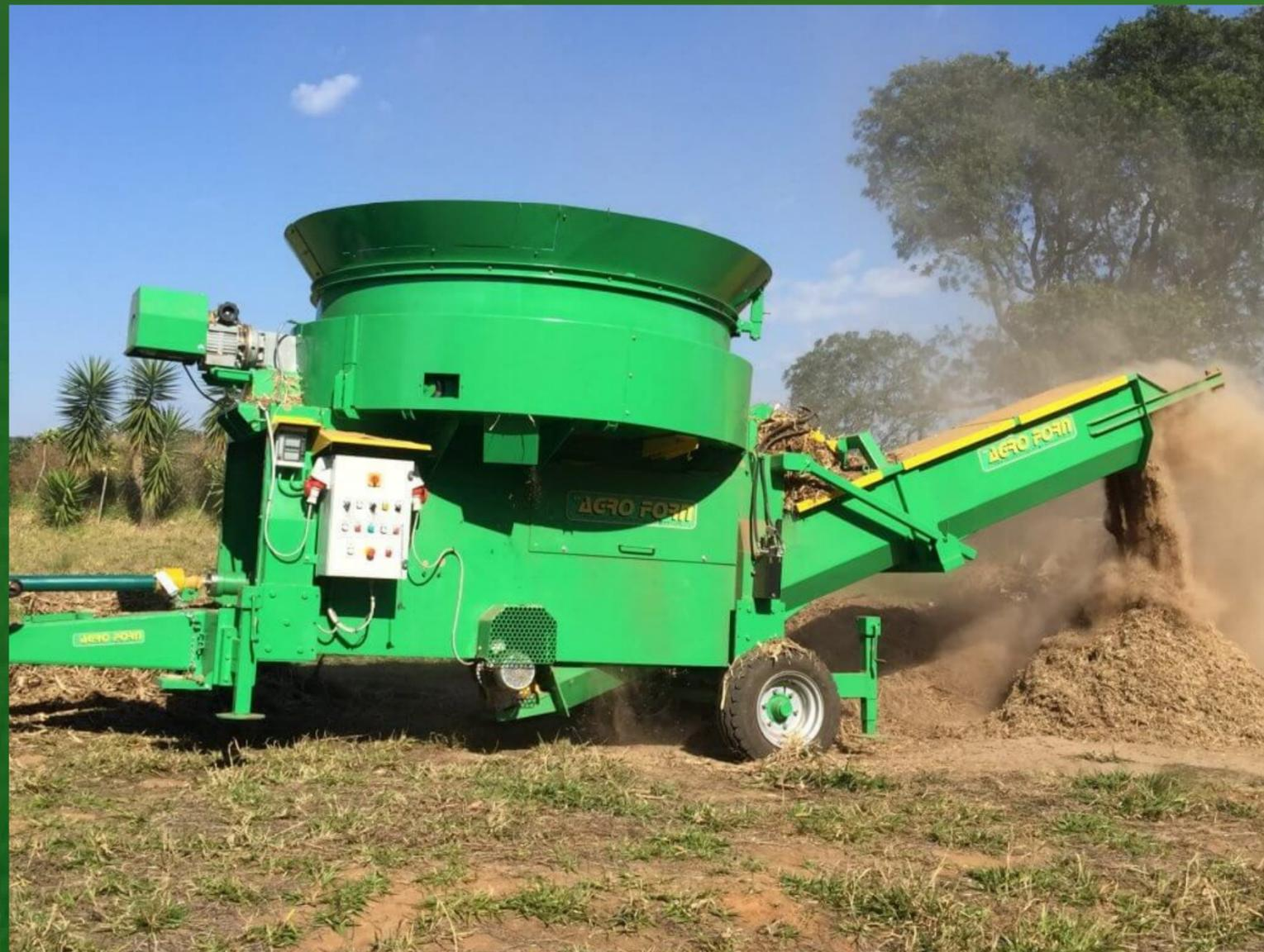
O Moinho AFM1200 da AGROFORN de fabricação nacional, possui 112 martelos, a máquina é adequada para triturar palha, feno, pré-secado, cereais e restos de madeira (máx. 6 diâmetro). A máquina também é dotada de rodas para transporte e acionada a trator (130 a 200cv a 1000rpm).
