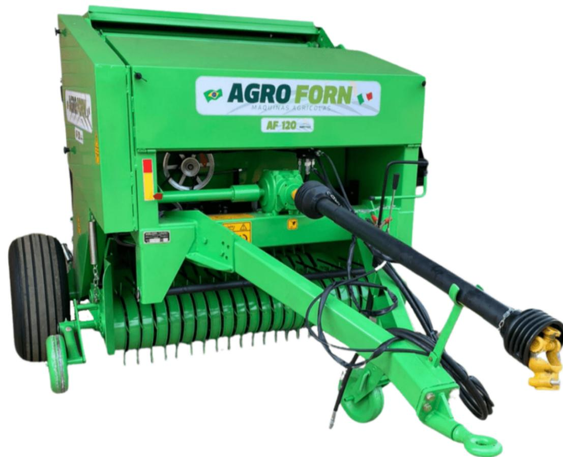
A Enfardadeira de câmara fixa para fardos cilíndricos AF120 da AGROFORN, é apropriada para recolher qualquer produto forrageiro para feno e silagem.
